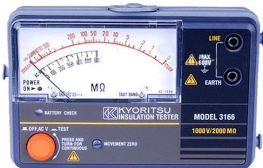
Рисунок 18 – Общий вид мегаомметров KEW 3166
