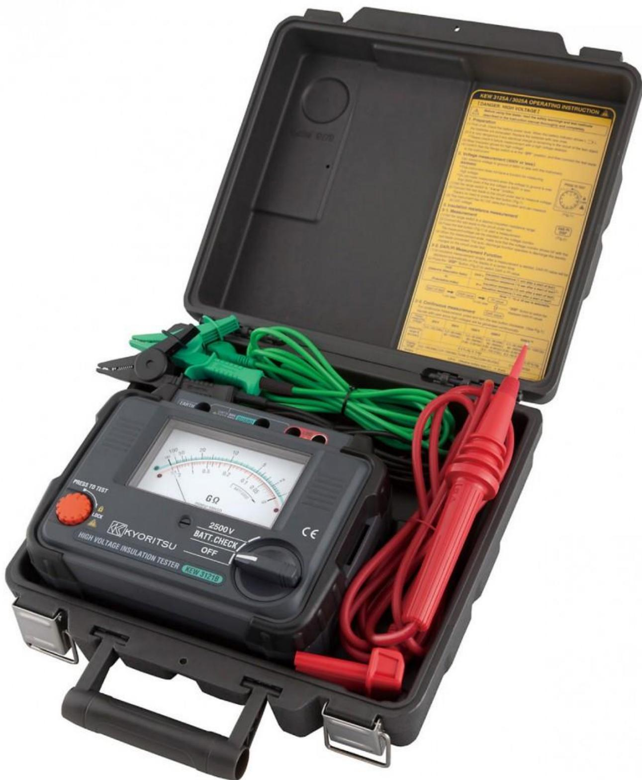
Рисунок 7 – Общий вид мегаомметров KEW 3121В
